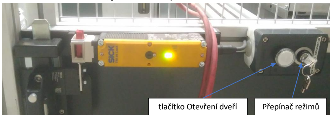
Obr. 1.13-2 Ovládací prvky – dveře k robotu
