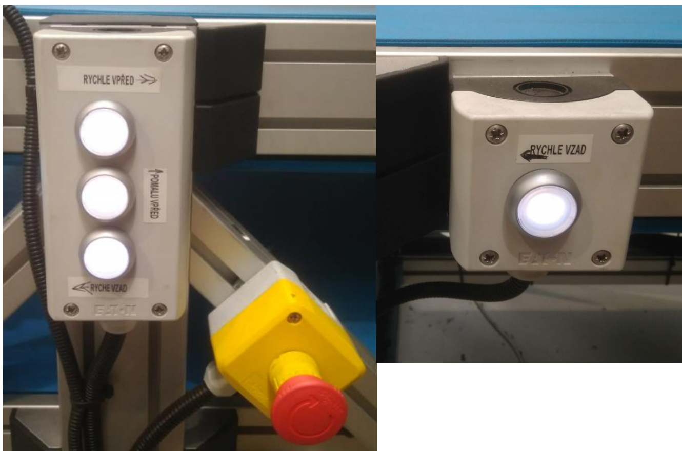
Obr. 1.13-3 Ovládací prvky dopravníku
