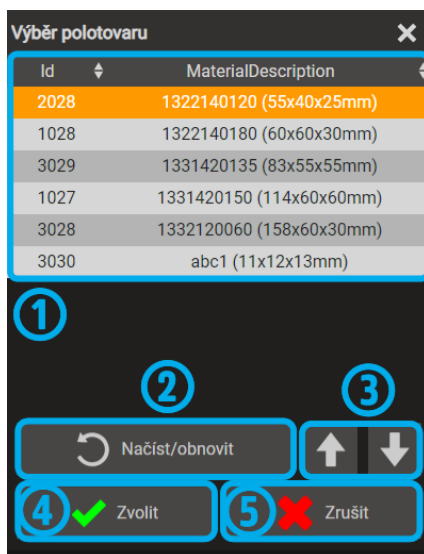
Obr. 3.2-4 Dialog pro výběr výchozího polotovaru výrobku
