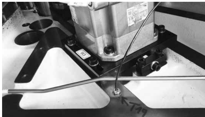
Příklad umístění teplotních čidel na stroji
