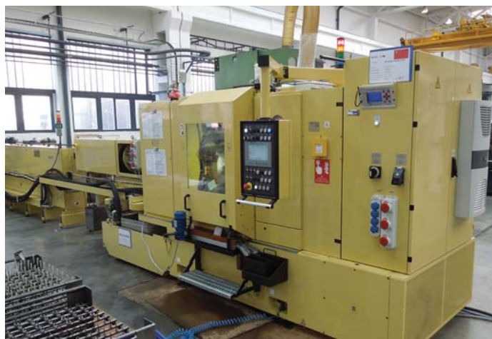
Osmivřetenový automat MORI-SAY 832AC – seřízený a připravený k expedici do Číny k zákazníkovi Schaeffler Technologies
