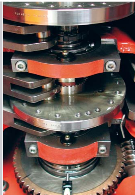
■ Pohony podélných suportů. Všechny čtyři větve pohonů suportů jsou chráněny nezávislými přetěžovacími spojkami
